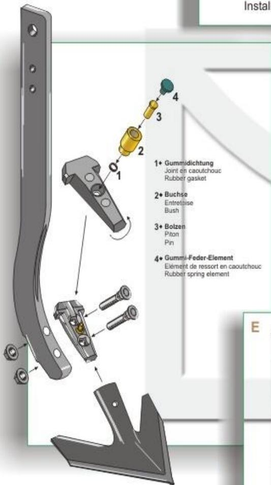
E: Der Halter wird mit zwei passenden Schrauben
